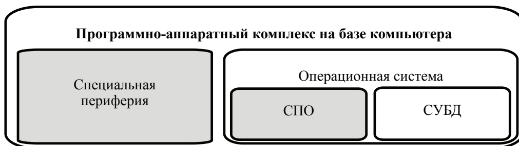
Рис. 1. Состав типового ПАК
