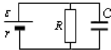
18 К источнику тока с ЭДС  $\varepsilon = 9$  В и внутренним сопротивлением  $r = 1$  Ом подключили параллельно соединённые резистор с сопротивлением  $R = 8$  Ом и плоский конденсатор, расстояние между пластинами которого  $d = 0,002$  мм. Какова напряженность электрического поля между пластинами конденсатора?
